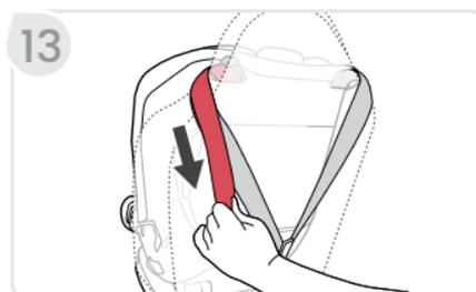
Instalación solo con orientación hacia adelante con cinturón de cadera (Tipo 1)
