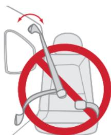
Cinturones de cadera y hombros con puntos de anclaje superiores o inferiores en la puerta del vehículo.
