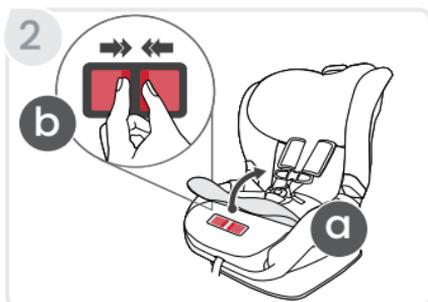
3. **Apriete** el resorte del conector inferior y levante el anclaje inferior.
