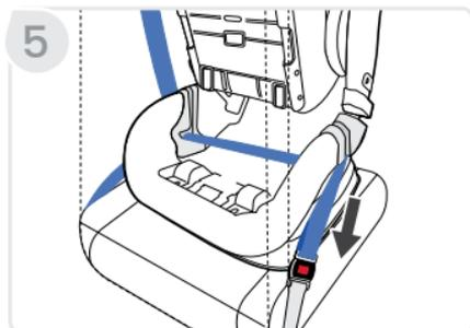
6. **Retire** el sobrante de la parte de la cadera (a) y luego de la parte del hombro (b) del cinturón de seguridad del vehículo.
