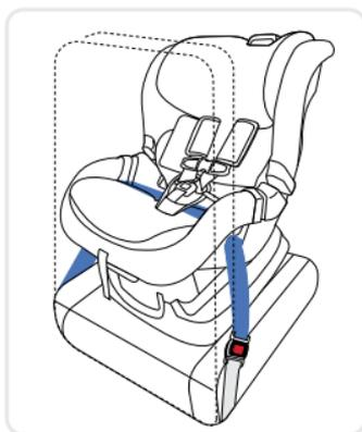
Para la instalación en aeronaves con orientación hacia adelante:
