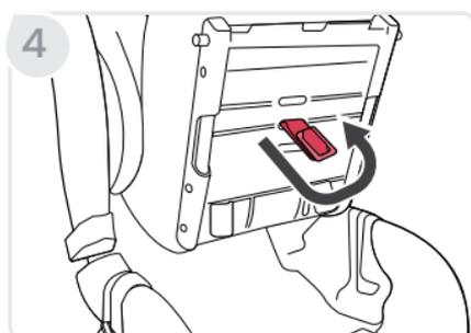
5. **Ponga** la correa de la hebilla en la posición deseada y **tire** el retenedor de la correa de la hebilla completamente por la ranura de la bandeja del asiento y la cubierta de la bandeja del asiento.
