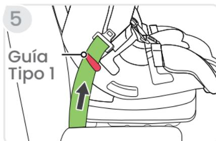
**IMPORTANTE:** NO pase el cinturón de seguridad del vehículo por **AMBAS** guías tipo 1. Solo debe de usarse la guía tipo 1 opuesta a la hebilla del vehículo.
