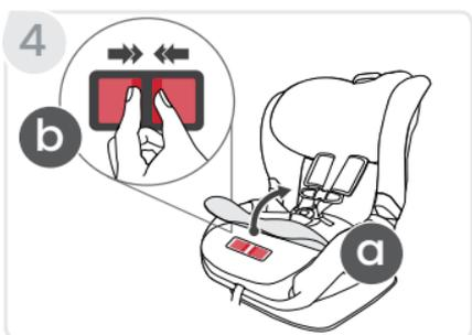
a. **Levante** la solapa de la cubierta delantera.
