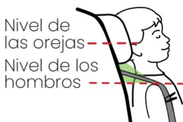
**IMPORTANTE:** Las almohadillas del arnés deben utilizarse con niños que pesen entre 10 kg - 29,4 kg (22 lb - 65 lb) con orientación hacia adelante, excepto para la instalación solo orientada hacia adelante del cinturón de seguridad de cadera (Tipo 1) las almohadillas del arnés deben almacenarse para niños que pesen menos de 11,3 kg (25 lb).
