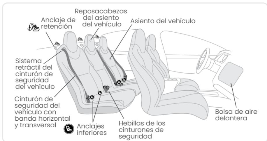
Los anclajes y amarres inferiores para niños o LATCH, es un sistema disponible en este asiento de seguridad para niños que ofrece una alternativa a los métodos de instalación del cinturón del asiento del vehículo. La figura de arriba muestra lugares típicos para anclajes inferiores y anclajes de amarre en un vehículo. Consulte las páginas 2 - 3 para los componentes LATCH en este asiento de seguridad para niños.
