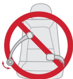
Cinturones de cadera con una placa de cierre cosida que tiene un retractor que se bloquea solo en caso de una parada repentina.
