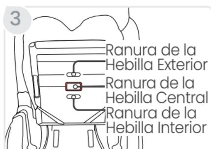
4. **Gire** el retenedor de la correa de la hebilla hacia los lados y **páselo** por la ranura de la bandeja del asiento y la cubierta de la bandeja del asiento.
